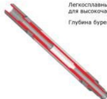
Рисунок 5 - Труба бурильная легкосплавная ниппельного соединения
