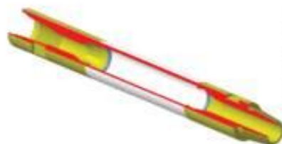
Рисунок 9 – Штанга к буровым станкам НКР-100
